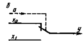
Рис. 13.21. Одноадресный мультиплексор на два входа (а) и его упрощенная схема (б)
